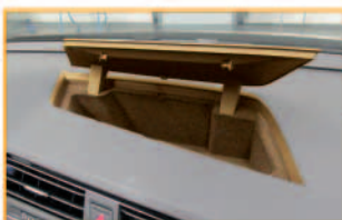
Ablagefach mit Deckel auf der Schalttafel
