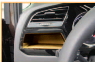
Ablagefach mit Medienanschlüssen vor dem Schalthebel
